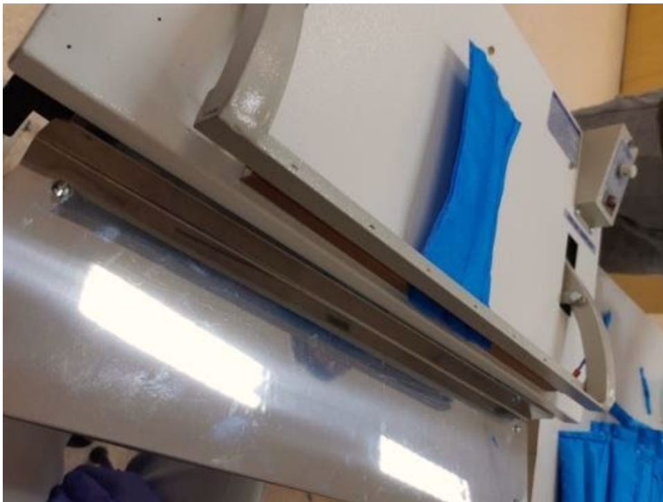
Figura 1: Uso da seladora para fechamento lateral.
